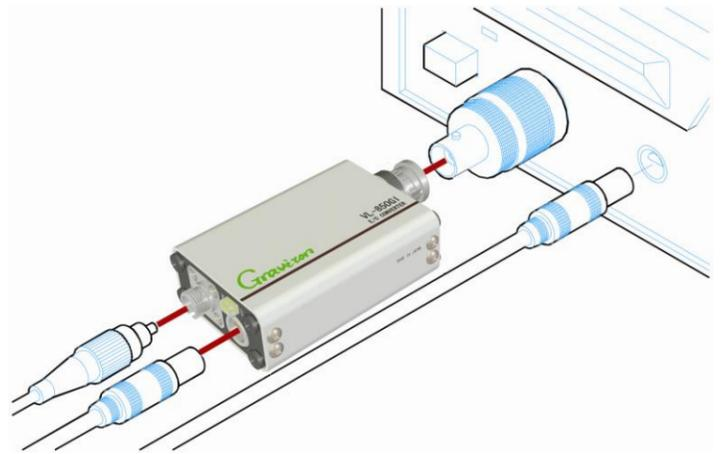
1、最初に本機を電子計測器の信号出力端子に装着します。計測器側端子が BNC ジャックで無い場合には、市販の変換コネクタを使用してください。
