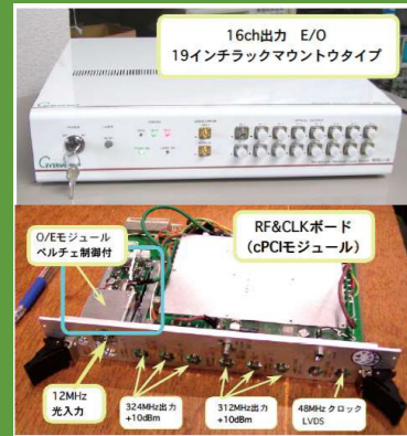
図2: (上)パルスドライバ内蔵広帯域E/O、(下)温度制御付O/E (cPCIボードに内蔵)。
