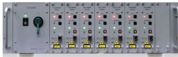
外観: フレームユニット+7モジュール+空きスロット1
